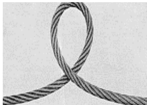
DETERIORO POR RISO
