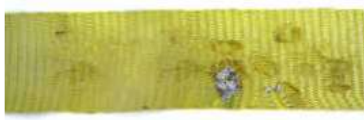
CHISPAS DE SOLDADURA
